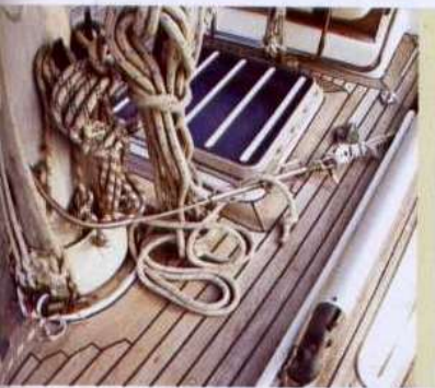
A destra, il piano di coperta visto da prua. Nella pagina a fronte il pozzetto. Sopra, il sistema di fissaggio dello stralotto quando non è in uso. Sotto, trasto e winch di scotta della randa.
