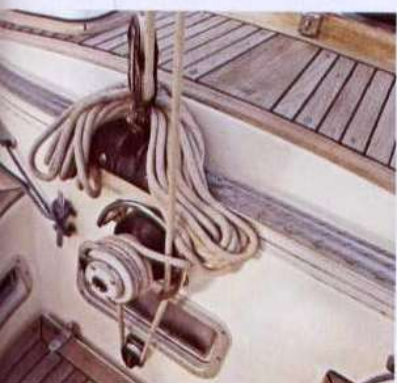
A destra, il piano di coperta visto da prua. Nella pagina a fronte il pozzetto. Sopra, il sistema di fissaggio dello stralotto quando non è in uso. Sotto, trasto e winch di scotta della randa.
